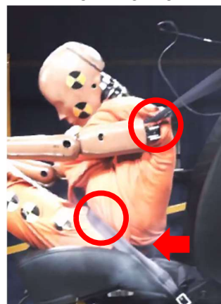
c) T-22259523 Produkt D: Bältesklämma - Bälte nedanför axel och över mage - Ökat höftframkast - Underglidning höger höft
