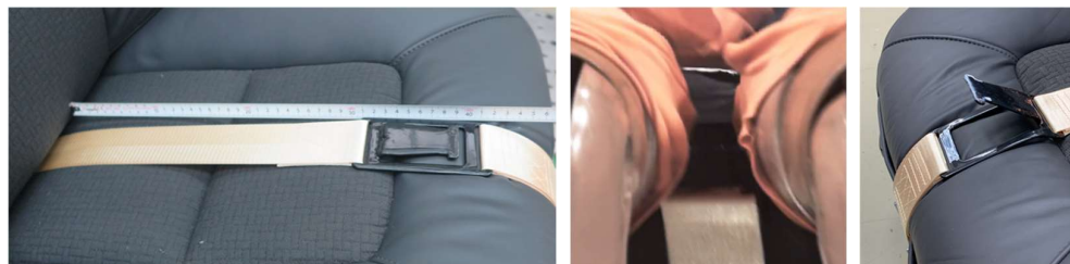
Figur 18. Test med Produkt C a) placering i sätet 390 mm från sätesryggen, b) kroken vreds uppåt och c) deformerades kraftigt.
