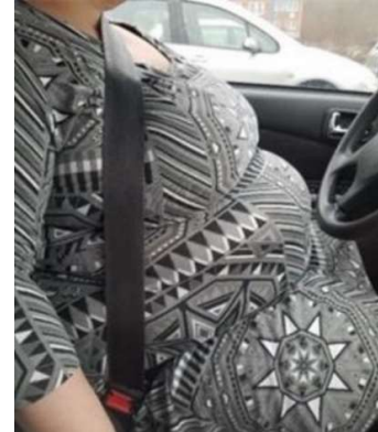
Figur 4. Exempel på hur diagonalbältet lägger sig ovanför bröstet och skaver mot halsen.
