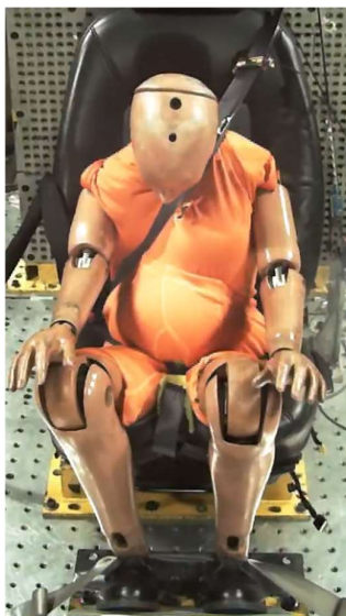
e) T-22259525 Produkt D: Bältesstoppare - Ingen större skillnad mot referens, men bältet ligger längre ut mot axel och överkroppen är mer vriden.
