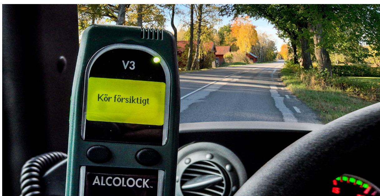
Alkolås i verksamhetens fordon är ett effektivt sätt att minska risken för att förare kör alkoholpåverkad.
