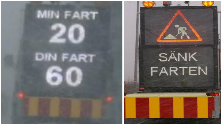
Figur 4. Dubbel funktion, tidsstyrd växling mellan två budskap. Bilderna tagna i snöväder, foto: VTI.
